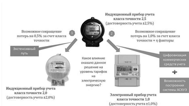
Так, например, на базе цеха технического обслуживания и ремонта приборов учета электрической энергии (ЦТОиРПУЭЭ) филиала «Энергосбыт» РУП «Витебскэнерго» в 2010 году было проведено исследование, обосновывающее необходимость и целесообразность замены индукционных приборов учета на электронные [1].
